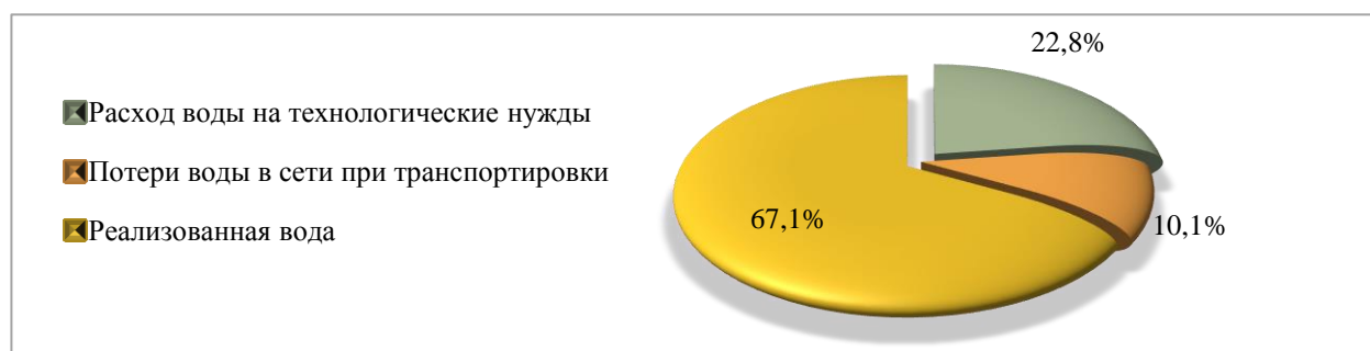
Рисунок 6 – Диаграмма, характеризующая баланс подачи и реализации воды по системе водоснабжения с.п. Ваховск
