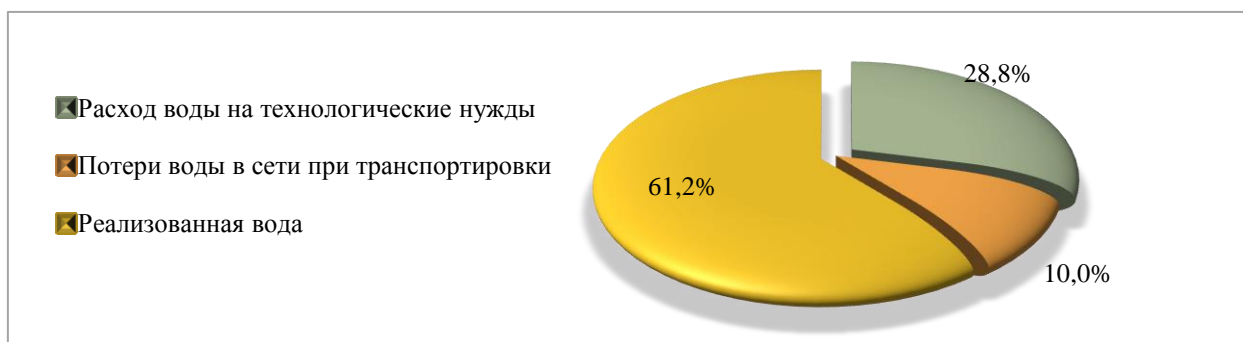
Рисунок 8 – Диаграмма, характеризующая баланс подачи и реализации воды по системе водоснабжения с. Охтеурье
