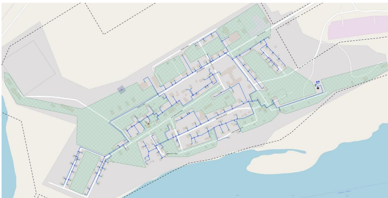
Рисунок 4 – Схема децентрализованного водоснабжения в с. Охтеурье
